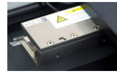
进口无铁芯直线电机 运行更平顺
